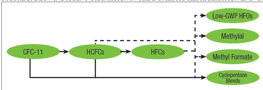
**FIGURE 4. REFRIGERANT TRANSITION IN THE UNITARY AIR CONDITIONING END-USE**
