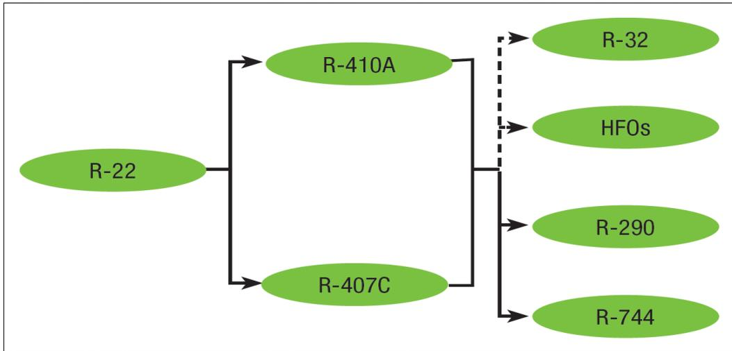
**FIGURE 5. REFRIGERANT TRANSITION IN THE COMMERCIAL REFRIGERATION END-USE (STAND-ALONE EQUIPMENT)**
